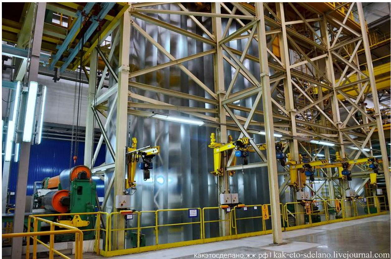
В общем, все происходит так: в барабан заряжается стальной рулон, он протягивается почти на километр и лист проходит через валки, которые находятся в ванне с краской, которая проходя через печь превращается в полимерное покрытие.
