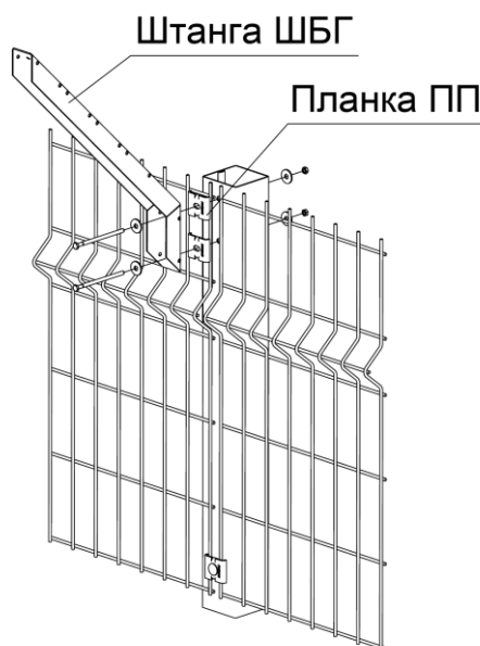
Рис. 3.5. Монтаж панелей Industrial 3D и Power 3D совместно со штангой верхнего барьера безопасности.
