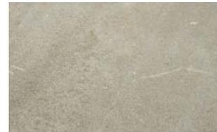
Рис. 6. Цементно-стружечные плиты (ЦСП)
